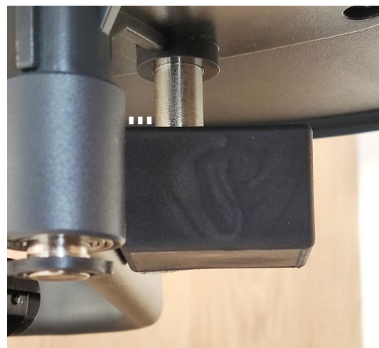
Ogranicznik w położeniu A Większy wysuw
